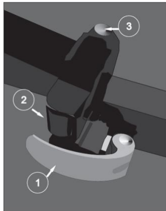
Fig. 1: Gesloten positie 1: Hendel 2: Verstelmoer 3: Scharnierpen
