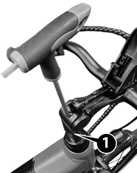
U kunt de stuurpen (1) losdraaien nadat u de klem hebt geopend, zoals uitgelegd op de ommezijde. Draai de pen zo ver los met imbus-sleutel 5 dat u het stuur naar boven of beneden kunt bewegen. **LET OP!** Niet verder uit het frame trekken dan de markering op de stuurpen. Draai de pen goed vast zodra deze op de gewenste hoogte staat.
